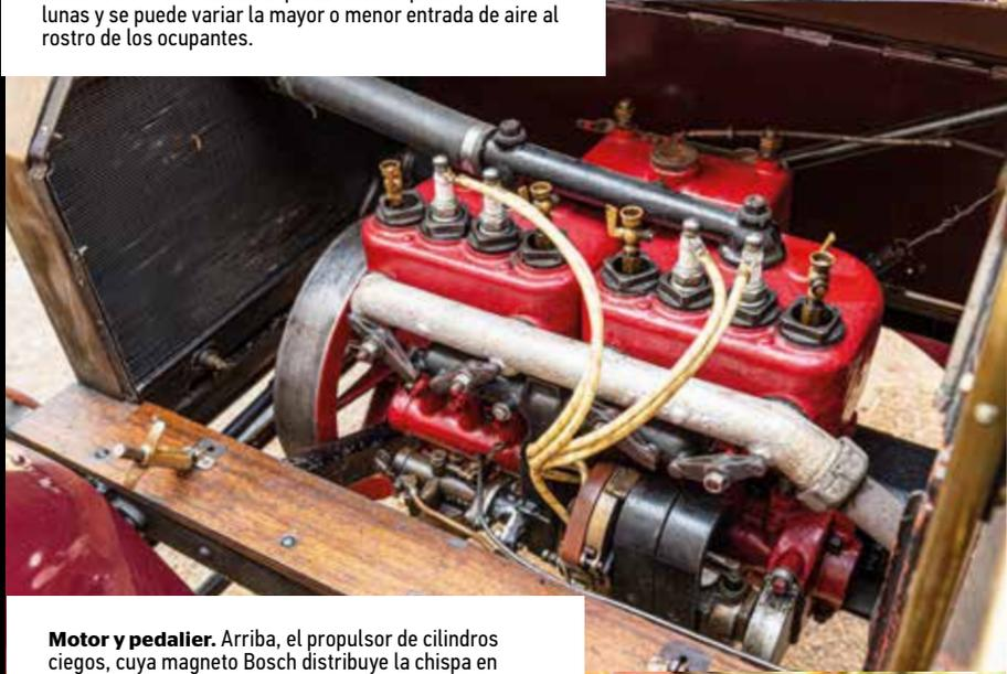
**Motor y pedalier.** Arriba, el propulsor de cilindros ciegos, cuya magneto Bosch distribuye la chispa en orden de encendido 1-2-4-3. Bajo estas líneas y de izquierda a derecha, el pedal del embrague, el central del acelerador y el derecho del freno.
