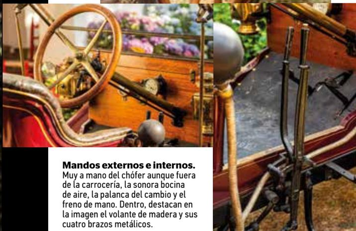
**Mandos externos e internos.** Muy a mano del chófer aunque fuera de la carrocería, la sonora bocina de aire, la palanca del cambio y el freno de mano. Dentro, destacan en la imagen el volante de madera y sus cuatro brazos metálicos.
