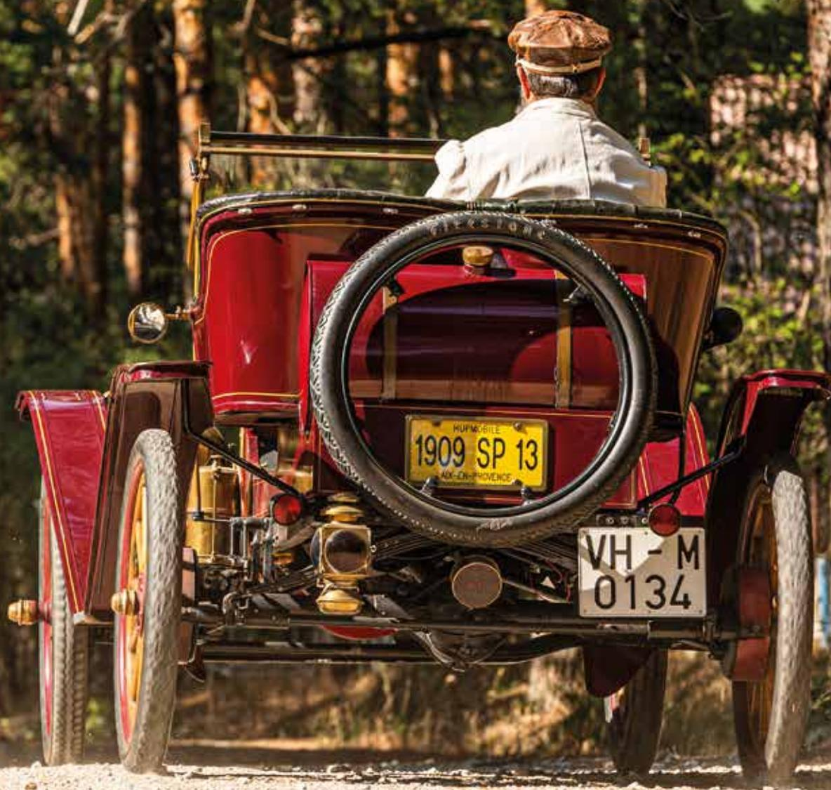
**La necesidad forzosa de iluminar.** Atrás y en posición baja, el farol posterior elaborado en latón. Por entonces se utilizaba queroseno como combustible y su luz avisadora de la presencia en movimiento del vehículo también se dirige hacia los dos laterales.
