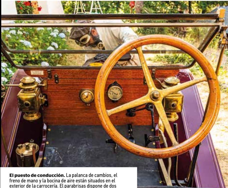
**El puesto de conducción.** La palanca de cambios, el freno de mano y la bocina de aire están situados en el exterior de la carrocería. El parabrisas dispone de dos lunas y se puede variar la mayor o menor entrada de aire al rostro de los ocupantes.
