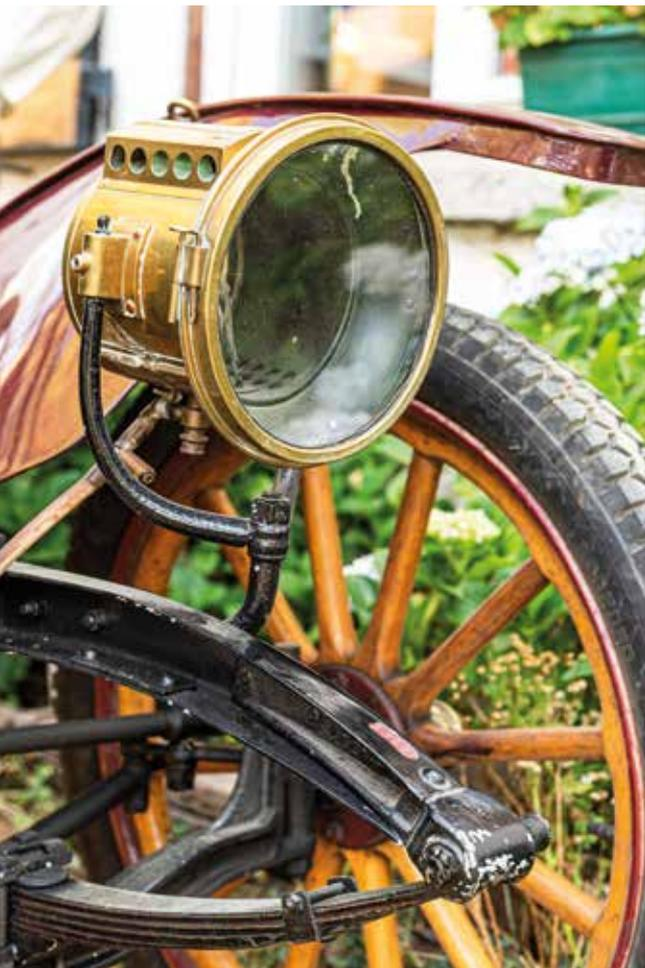
**Las luces de la época.** Arriba, uno de los dos faros de acetileno, que proporcionan un haz blanco y potente. Bajo estas líneas y situado al lado de parabrisas, fero elaborado en latón que ilumina con la utilización de petróleo.
